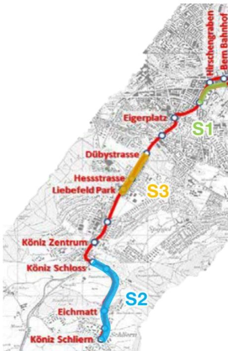
Abbildung 15: Mögliche Fahrleitungsabschnitte für die Trolleybusvarianten. S1: Bahnhof – Monbijou. (Umlauf 1.3 km), S2: Köniz Schloss – Köniz Schliern (Umlauf 3.287 km), S3: Dübystrasse – Brühlplatz (Umlauf 2.4 km).
